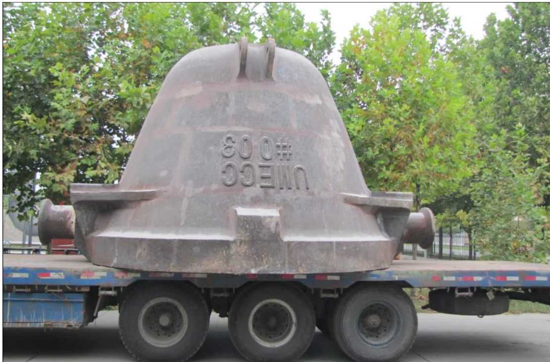
因转运设备限制耳轴中心距而变异设计的渣罐
