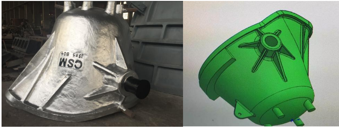
渣罐工艺编制，浇注模拟
